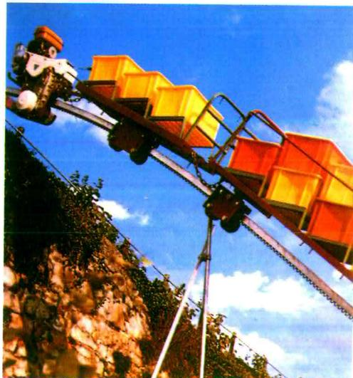
Fig. 4.33 - Per il trasporto dell'uva vendemmiata nelle condizioni più difficili di pendenza ed accessibilità del vigneto si ricorre tradizionalmente a fili a sbalzo con pianale di carico o più modernamente al Monorack i cui pianali sono predisposti in modo da evitare il rovesciamento delle ceste.
