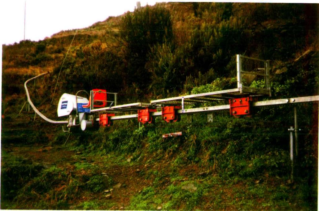
Fig. 5.5. - Sistema di trasporto a cremagliera (Monorack) adottato nelle Cinque Terre. Esso è costituito da una monorotaia dentata sulla quale scorre il mezzo di trasporto costituito da un primo carrello dotato di motore e di posto di guida, seguito da altri due carrelli per il trasporto.
