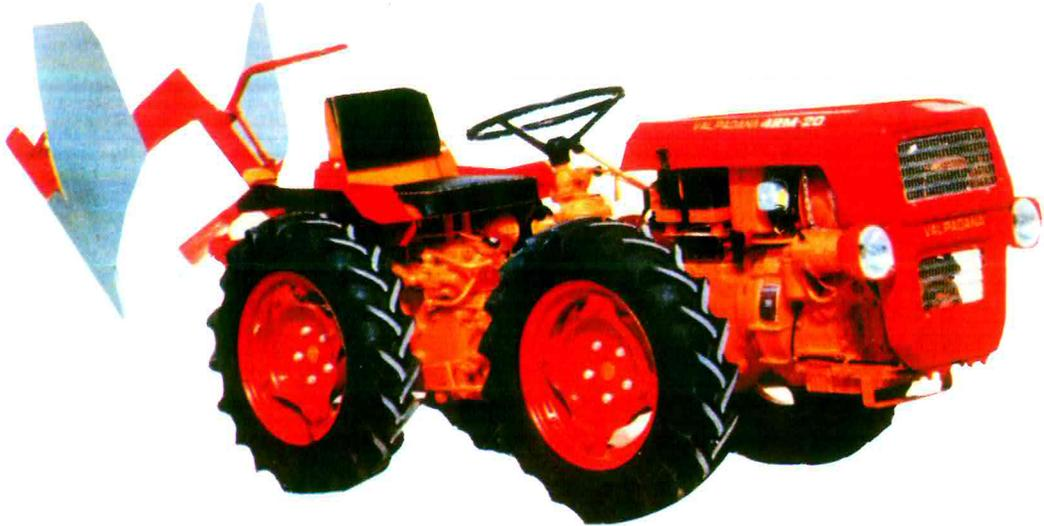
Fig. 4.18 - I piccoli trattorini, a quattro ruote motrici, derivati dal motocoltivatore, sono molto diffusi nella viticoltura ligure, per la loro versatile adattabilità al difficile ambiente montano.
