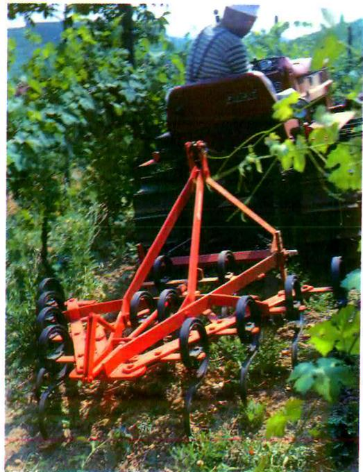
Fig. 4.19 - La trattrice, nelle zone in cui può essere impiegata, offre ampie possibilità di meccanizzazione del vigneto, grazie ai numerosi attrezzi applicabili: in questo caso (a destra) un coltivatore a larghezza variabile, con denti flessibili, utili per suoli ricchi di scheletro.
