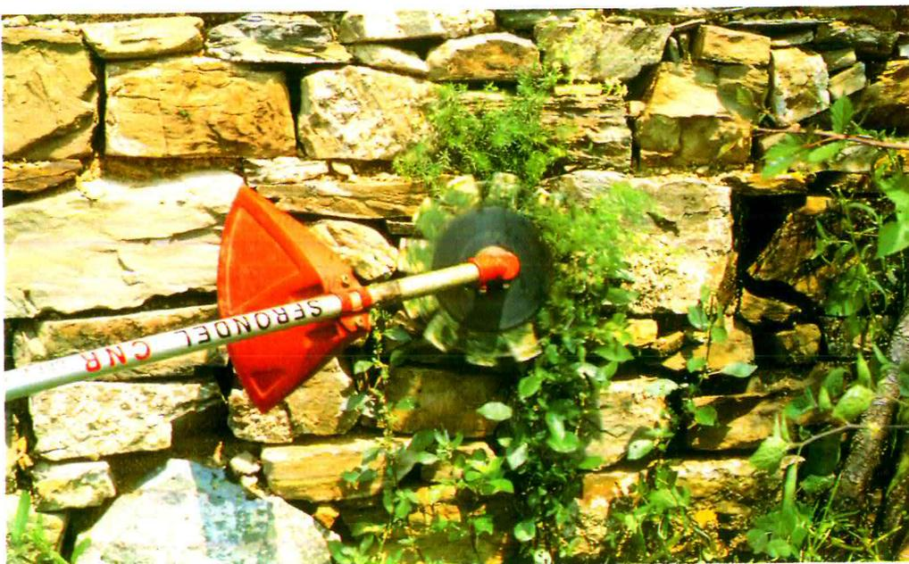
Fig. 4.31 - Per rendere più rapida e meno faticosa l'esecuzione di molti lavori (falcatura, pulitura dei muretti dalle infestanti, lavorazioni superficiali, cimatura, ecc.), il decespugliatore costituisce una macchina validissima e che occorrerebbe ulteriormente perfezionare dal punto di vista costruttivo. Con dispositivi di sicurezza può essere impiegato anche contro specie legnose sui muretti di sostegno delle terrazze.
