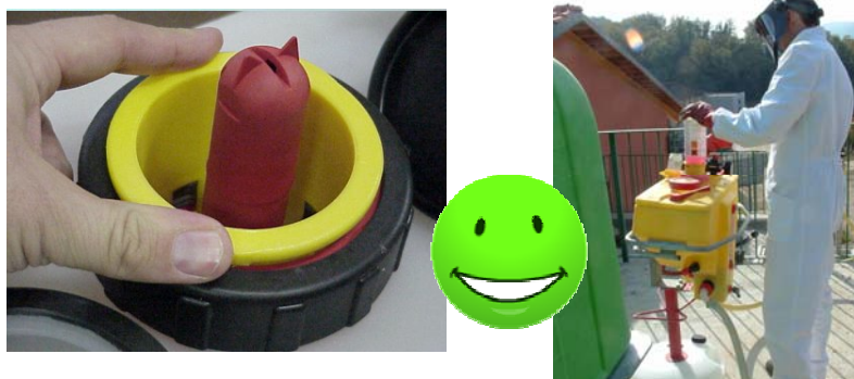
Fig. 66 - Esempi di ugelli lavabarattolo sul pre-miscelatore
