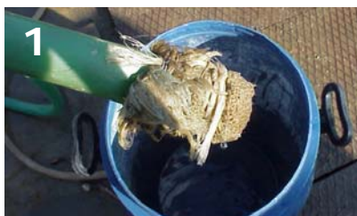
1 - Filtro non adeguato
