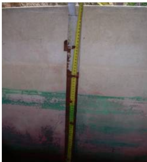
Fig. 34 – Soluzione artigianale per valutare la quantità di liquido presente nel serbatoio.
