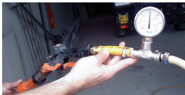
Fig. 18 - Particolare del "raccordo" che consente di montare un manometro in prossimità della lancia al fine di valutare la reale pressione di esercizio.
