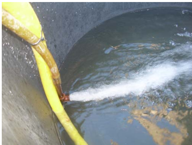
Fig. 39 – Agitazione garantita dal ritorno della pompa nel serbatoio della miscela fitoiatrica.
