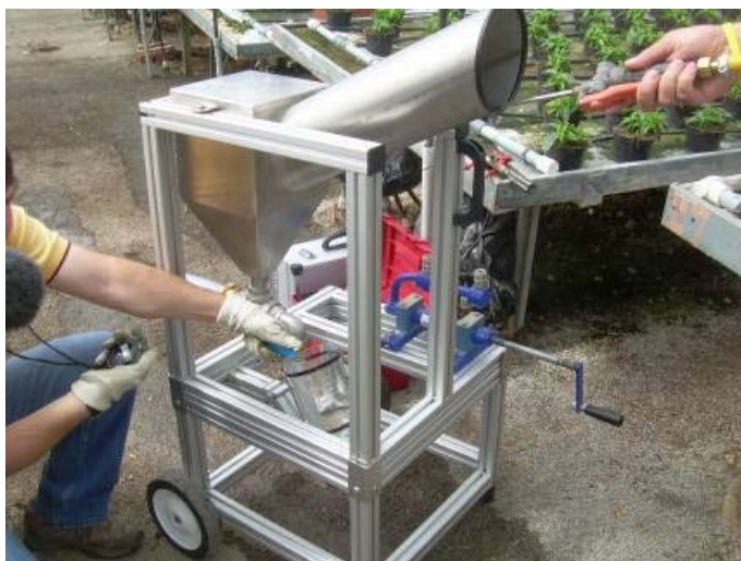
Fig. 26 – Misurazione della portata della lancia.
