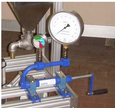
Fig. 17 – Banco prova per la valutazione della precisione del manometro
