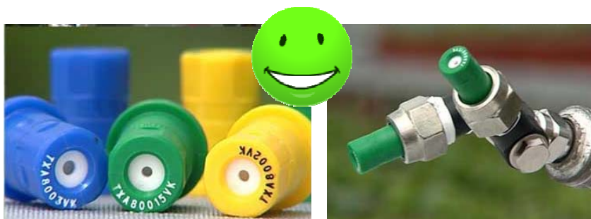
Fig. 55 – Ugelli certificati ISO e loro montaggio su una lancia aziendale mediante apposito raccordo
