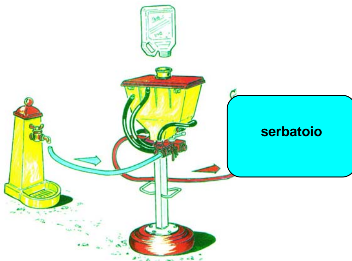
Fig. 65 - Esempio di premiscelatore autonomo alimentati dalla rete idrica aziendale.
