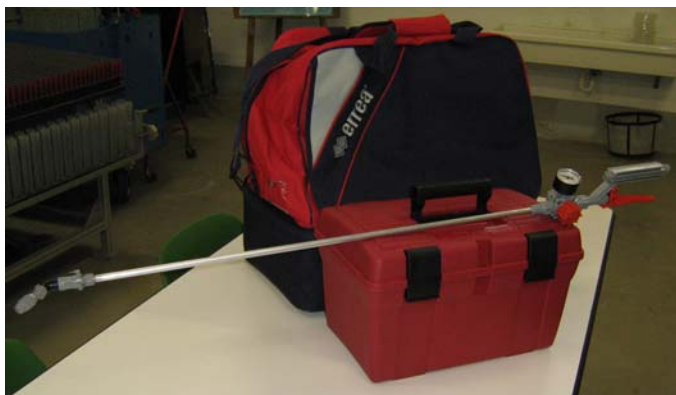
Fig. 20 – Sacca per il trasposto dell'attrezzatura, cassetta attrezzi ed esempio di lancia dimostrativa con regolatore e manometro forniti ai Centri Prova.
