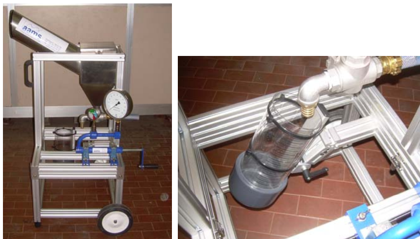
Fig. 16 - Attrezzatura per la determinazione della portata della lancia con particolare del cilindro graduato.
